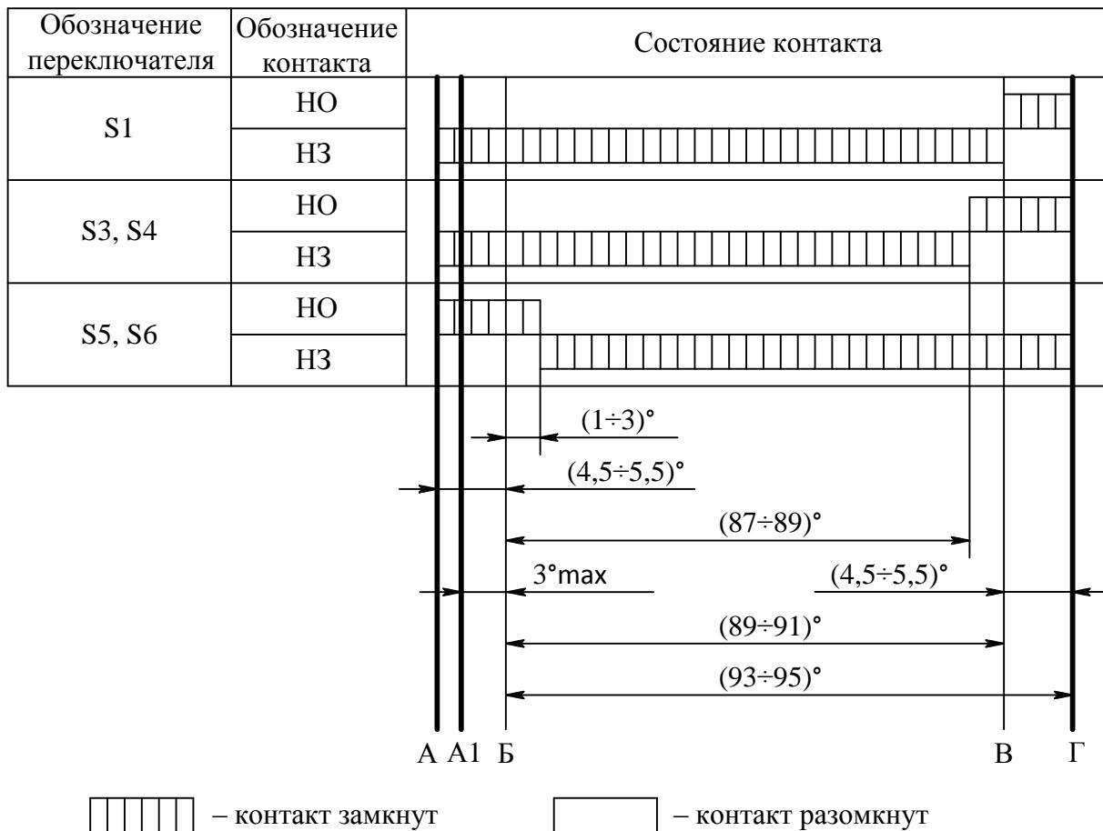
А, Г – внутренние механические упоры механизма
